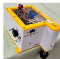
共同研究によって開発した溺水リスク低減のための排水機構のコントロール装置（プロトタイプ）
